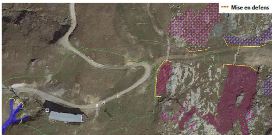
Mise en défens des zones humides situées autour des terrassements de la gare intermédiaire et des zones humides situées en bordure de la piste de ski autour du P4_KARUM
